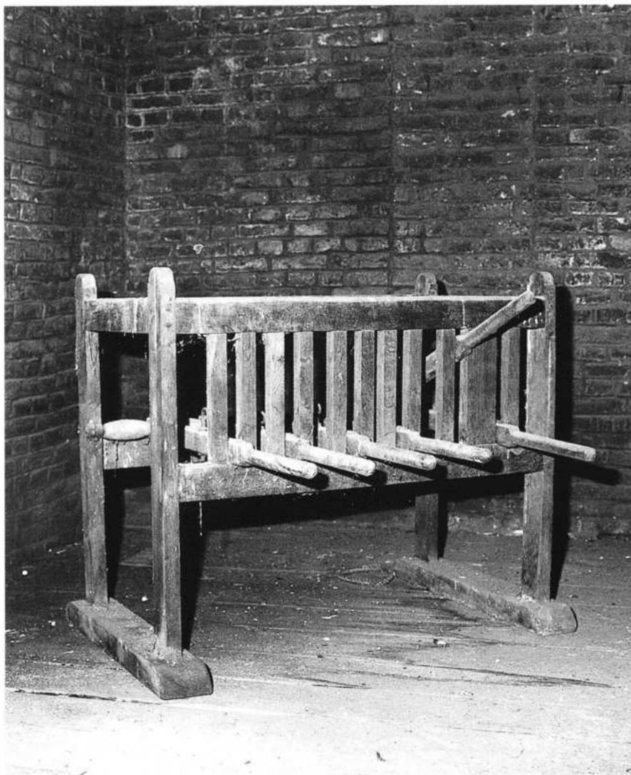
Fig. 3. Clavier à tinter. Le bâton levé indique le sens de la traction (cliché Ph. Bockstael).
